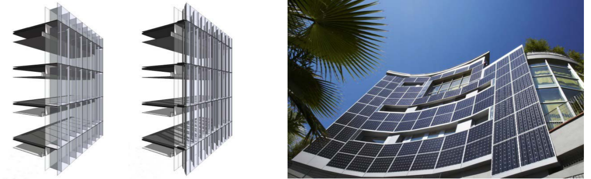
Resim 27. Fotovoltaik Perde Duvar Detay ve Cephe
